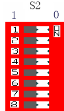
图 3-1 设置波特率的拨码开关 S2
